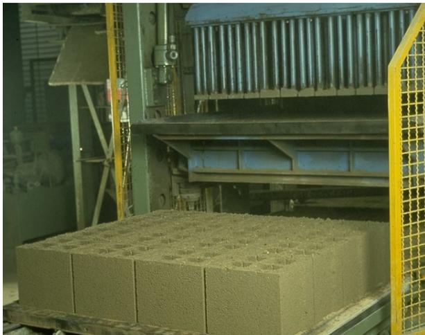
Bild 9: Hohlblocksteine auf dem Unterlagsbrett eines stationären Steinfertigers
