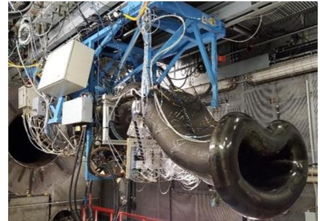
Versuchsaufbau mit dem stark gekrümmten Triebwerkseinlauf „MEIRD“ am Larzac 04 Triebwerk
