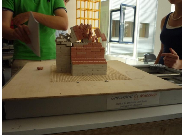
Erdbebenuntersuchung am Rütteltisch der Forschungsgruppe BauProtect (Foto Norbert Gebbeken)
