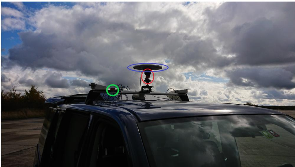
**Abbildung 4.1:** Messbus mit IMU (links); Prisma (rechts unten) und GNSS Antenne (rechts oben)
