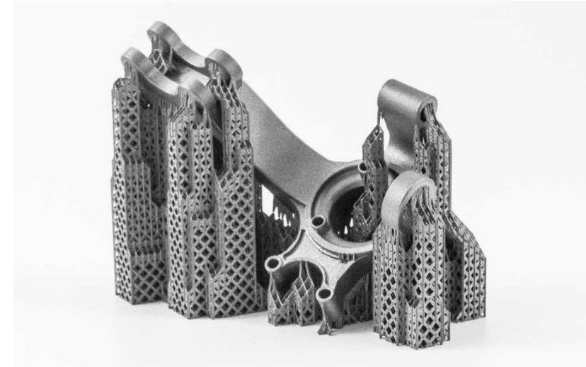
Abb.: Mittels LPBF gefertigtes Bauteil inklusive Stützstruktur aus Titan [2].
