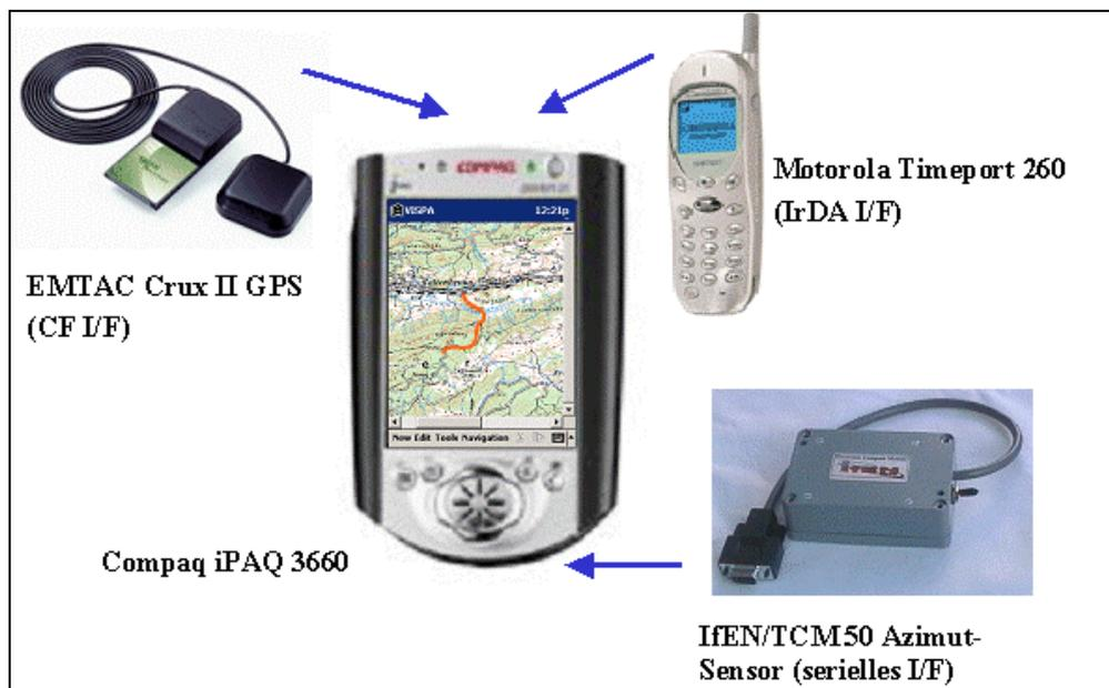
Abb. 4: HW-Konfiguration des TourGuide
