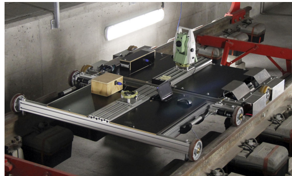
Abbildung 4: Gleismesswagen RACER II.
