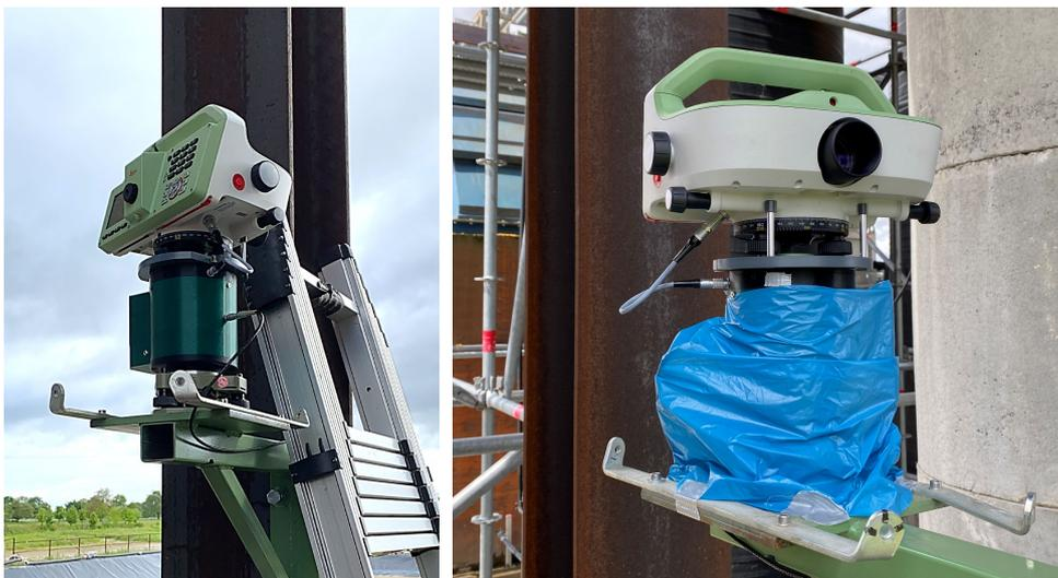
Abbildung 6.9: Einsatz des motorisierten Digitalnivelliers auf einer Baustelle zur Überwachung einer Mörtel-Injektion
