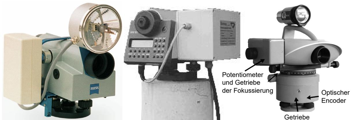
Abbildung 6.1: Links: motorisiertes Zeiss DiNi 10 mit Aufsatzbeleuchtung [Solexperts AG 1999]; Mitte: DiNi 10 T [Menzel 1999]; Rechts: DNA03 mit Motorisierung der Fokussierung und Dreheinheit um die Stehachse mit Kontrolleinheit [nach Pellegrinelli et al. 2013]
