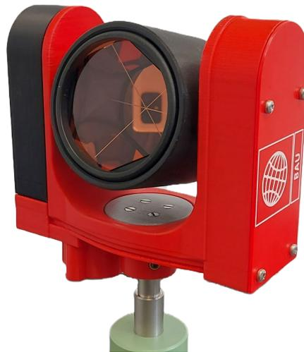
Abbildung 7.3: Motorisiertes Prisma mit dem Glaskörper eines Leica GPR1
