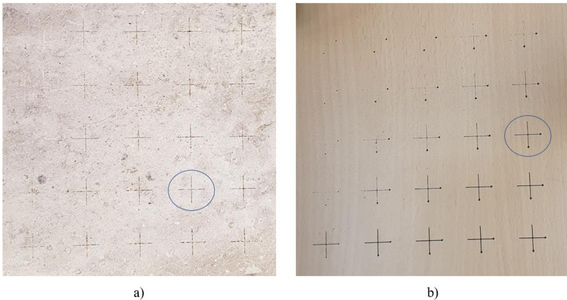
Abbildung 9-6: Ergebnis des Matrix-Tests auf a) Betonboden (langsame Verfahren), b) beschichtetem Betonboden (schnelle Verfahren)
