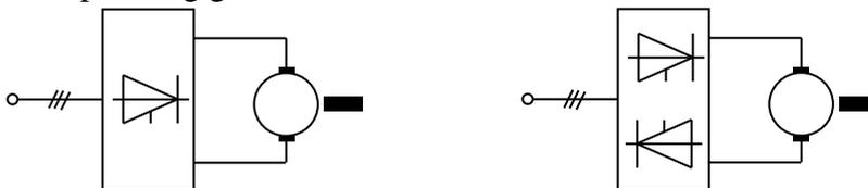
Eine gesteuerte Drehstrombrückenschaltung (siehe Bild links) lässt einen 2-Quadranten-Betrieb zu (keine Rückspeisung möglich); die Gegenparallelschaltung zweier gesteuerter Drehstrombrückenschaltungen (siehe Bild rechts) lässt 4-Quadranten-Betrieb zu. Prinzipschaltung, Schaltdiagramm und Spannungen einer Drehstrombrückenschaltung sind in den folgenden Bildern dargestellt:
